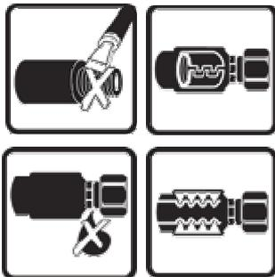
Patentovaný systém MegaCrimp sC – vložkou v objímce zalisované přímo na koncovce je unikátní. Spolu s bezořezovou aplikací až do průměru DN 32 snižuje možnost technologické i lidské chyby při armování hadice. Zároveň tato technologie zajišťuje perfektní zakousnutí objímky do opletu hadice a tím perfektní těsnost spoje hadice-koncovka.
